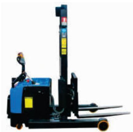
**EMPILHADEIRA ELÉTRICA EMBARCADA POR PLATAFORMA**
