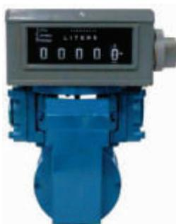
**BLOCO VOLUMÉTRICO DE PALHETAS COM NUMERADOR**
