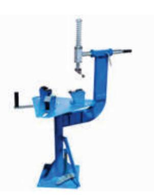
**MONTADOR / DESMONTADOR PARA PNEUS DE MOTO**
