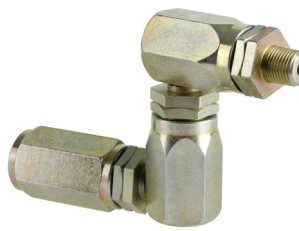
CONEXÃO GIRATÓRIA - TIPO Z - Em aço - Articulação 360° - Pressão de trabalho 400 Bar - Rosca NPT
