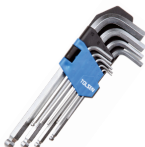
JOGO DE CHAVE ALLEN ABAULADA LONGA - 9 PEÇAS - Em aço cromo vanádio - Utilizado em ângulo de até 25° em relação ao eixo do parafuso Composição: - Chaves 1,5 - 2,0 - 2,5 - 3,0 - 4,0 - 5,0 - 6,0 - 8,0 - 10 mm
